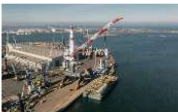
BU: Umschlag von Monopiles mit dem Hafentalkran TCC 78000
